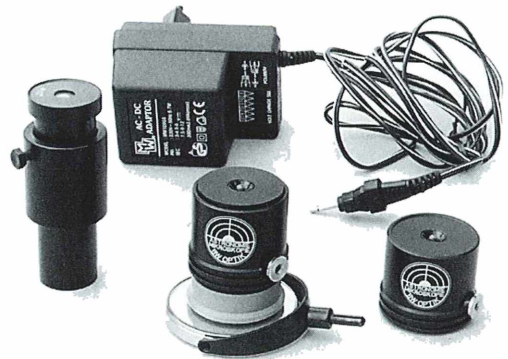
Abb. 1: Die wichtigsten Komponenten der Beleuchtungseinrichtung: Zentrierfernrohr, auf den Spiegel aufgeklebter Magnet mit aufgesetztem Beleuchtungstopf, Wechseltopf, Trafo mit Spannungswahlschalter.
