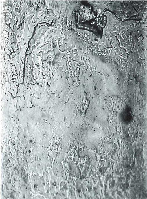
Abb. 4: Spaltbruch in Bruchfläche von weiß erstarrtem Gusseisen, oben links ein Seitenriss (Lackabdruck); Vergr. 150×.
