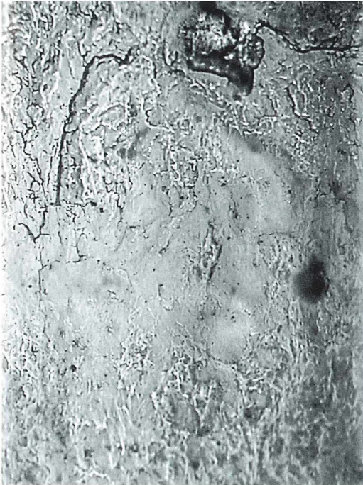
Abb. 4: Spaltbruch in Bruchfläche von weiß erstarrtem Gusseisen, oben links ein Seitenriss (Lackabdruck); Vergr. 150 \times .
