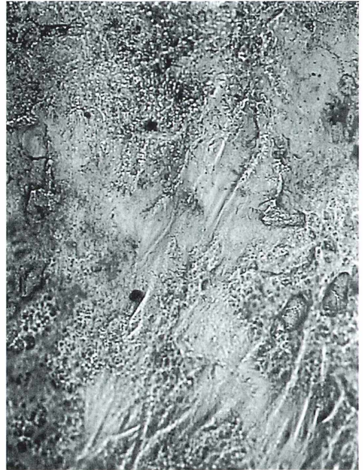
Abb. 5: Mischbruch (Waben und Spaltflächen) vom Schlauder (Lackabdruck); Vergr. 150 \times .
