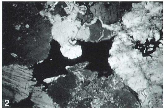
Abb. 1 und 2: Gesteinsdünnschliffe unter gekreuzten Polarisatoren im Mikroskop. Vergr.: 20×. – Abb. 1: Gabbro (Handelsname Impala) aus Südafrika. – Abb. 2: Migmatit (Handelsname Paradiso) aus Indien.
