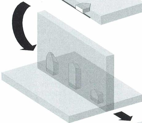
**Schritt 5:** Fixierung des halbierten Präparates auf zweitem Objektträger
