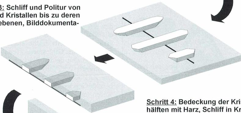
**Schritt 4:** Bedeckung der Kristallhälften mit Harz, Schliff in Kristalllängsrichtung, Halbierung der Körner
