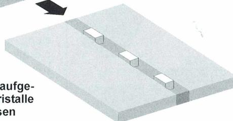
**Schritt 6:** Schliff und Politur des aufgeklebten Objektträgers, bis Restkristalle eine Dicke von ca. 30 µm aufweisen
