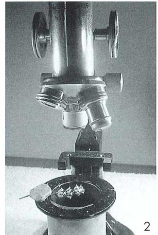
Abb. 1: Ein altes Voigtländer-Mikroskop eignet sich nach Entfernung von Objektstisch, Kondensator und Spiegel ideal für Auflichtaufnahmen. Drei Blitze sorgen für eine weiche Ausleuchtung. – Abb. 2: Die Objekte (hier ein *Salvia*-Fruchtstand) werden auf einer breitkrepigen Messingröhre für die Aufnahmen ausgerichtet. Der Arbeitsabstand liegt für 3,3fache beziehungsweise 5,8fache Vergrößerung auf Kleinbild zwischen 8,2 und 2,8 cm.
