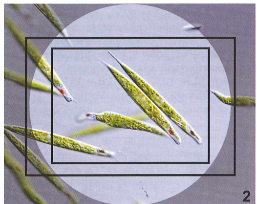
Abb. 2: Aufnahmeformate unterschiedlicher Sensorgrößen. Bildkreis entspricht einem Leica Okular 10\times , SFZ 22. Der äußere Rahmen zeigt den Bereich, den ein APSC-Sensor aufzeichnet. Der innere Rahmen zeigt den Bereich, den ein Four-Thirds Sensor abdeckt.
