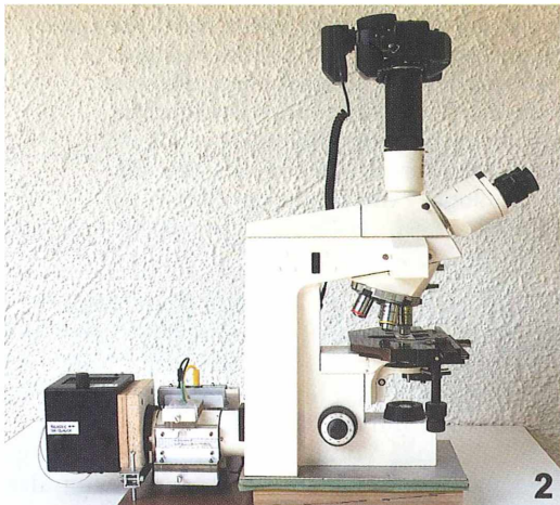
Abb. 1: Skizze zum Strahlengang. Lampe/Doppelkollektor/Mikroskop. Die Verbindung zum Lichtsensor im Blitzgehäuse erfolgt über das Aluminiumrohr mit innen liegendem Plexiglasstab. Der Doppelkollektor wird seitlich im Zentrum der Blitzröhre aufgebohrt. – Abb. 2: Gesamtansicht des Mikroskops mit angesetzter Lampe und Mikroblitz-Einheit.
