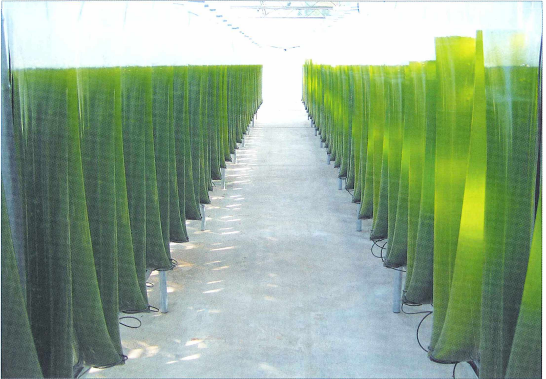
Abb. 2: Die Fotobioreaktoren: Transparente, mit Algensuspension gefüllte Plastikschläuche.
