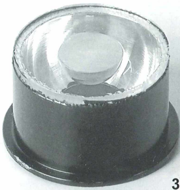
Abb. 3: Selbst gebauter Dunkelfeldkondensor. – Abb. 4: Rädertier im durch den Selbstbau-Dunkelfeldkondensor hergestelltem Dunkelfeld.
