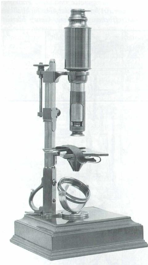
**Abb. 2: Mikroskop des Cuff-Typs, von G. Sterrop, um die Mitte des 18. Jahrhunderts (Quelle: Carl Zeiss Archiv).**
