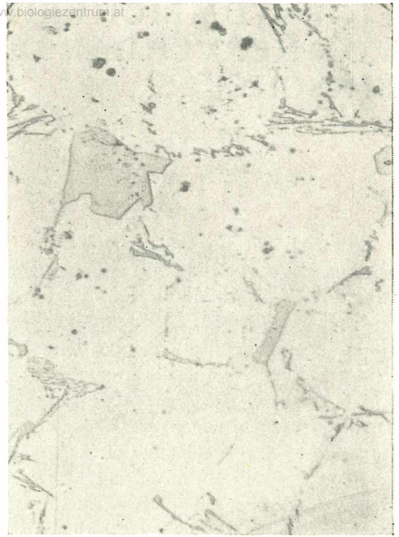
Abb. 13. Gefüge einer Legierung mit 6% Si, 5,5% Fe und 0,5% Mn, langsam abgekühlt; 200fach.
