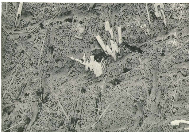
Abb. 11. Dieselbe Siemens-Martin-Schlacke wie in Abb. 5, jedoch mit \text{HF} geätzt, das allein den Wüstit färbte (im Bild die schwarzen Punkte). 100:1.
