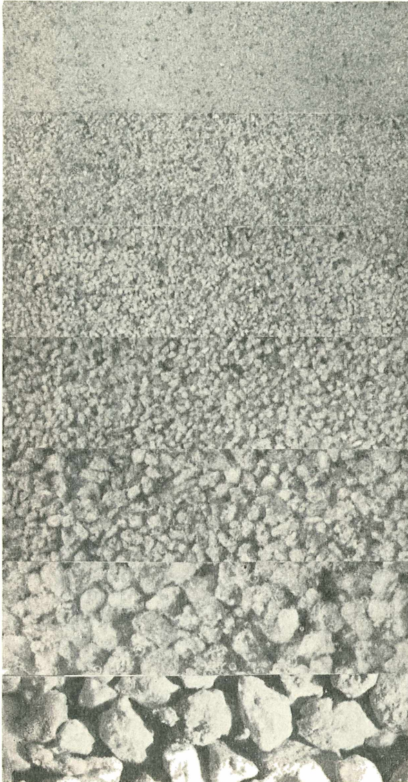
Abb. 6. Vergleichsskala von gesiebter Erde, 10 1 im Original.
