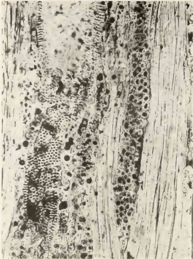
Abb. 7: Tangentialschliff. Schwach heterogener Holzstrahlen, Gefäße mit alternierenden, kleinen Tüpfeln. Inventar-Nr. BSP 1971 I 57. \times 315 .
