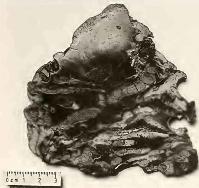
Abb. 2: Anschliff, quer. Bohrgänge von *Teredo* mit Füllsubstanz; Inventar-Nr. 1987 I 131.
