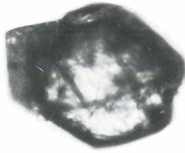
Abb. 12: Idiomorpher Zirkon mit authigenem Anwachstum in der (b-c)-Ebene. Kornlänge: 0.093 mm.
