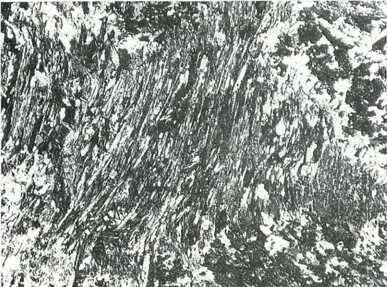
Abb. 2: Aus Saussurite-Gabbro, Würmschotter, Brucknerstraße in Graz. — Uralit nimmt fast die ganze Bildfläche ein: Bündel schilfiger Stengel, örtlich durchwachsen von fast farblosem Chlorit. Hornblendekorn = 2,1 x 3,2 mm. — Nic. +.
