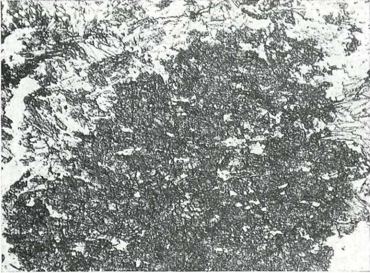
Abb. 1: Aus Saussurit-Gabbro, Würmschotter, Brucknerstraße in Graz. — Im Bilde die Hälfte eines Labradoritkorns mit Saussurit. Helle Begrenzung = Korngrenzen. Gesamtkorn = 2,4 x 3,0 mm. — Ohne Pol.
