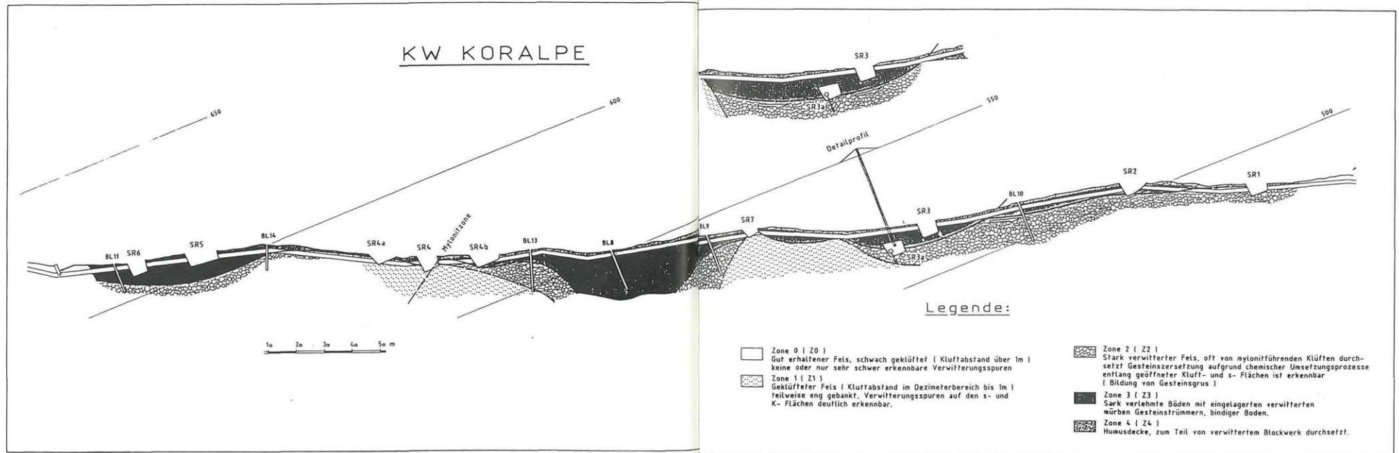
Abb. 3: Geologischer Längenschnitt entlang der Rohrleitungskünette von Station 950 bis 1370.
