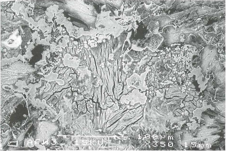
Abb. 9: Katoit in körnigen Aggregaten mit Ettringit/Thaumasit, Afwillit, Pyroxenen und den röntgenamorphen Ca-Al-Si-Mineralphasen; Steinbruch Klöch, Nördlicher Bruch, Klöcher Klause, Steiermark, Österreich. REM: BSE-Bild. Bildbreite: 0,3 mm.
