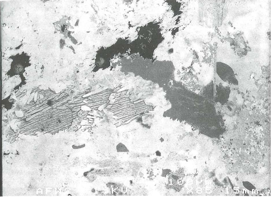
Abb. 5: Hydrotalkit (mittelgrau) mit Ettringit/Thaumasit, Tobermorit und Tacharanit; Steinbruch Klöch, Nördlicher Bruch, Klöcher Klause, Steiermark, Österreich. REM: BSE-Bild. Bildbreite: 1,1 mm. Hydrotalcite (color middle grey) with ettringite/thaumasite as well as tobermorite and tacharanite; basalt quarry Klöch, northern quarry, Klöcher Klause, Styria. BSE-image. Image width: 1,1 mm.
