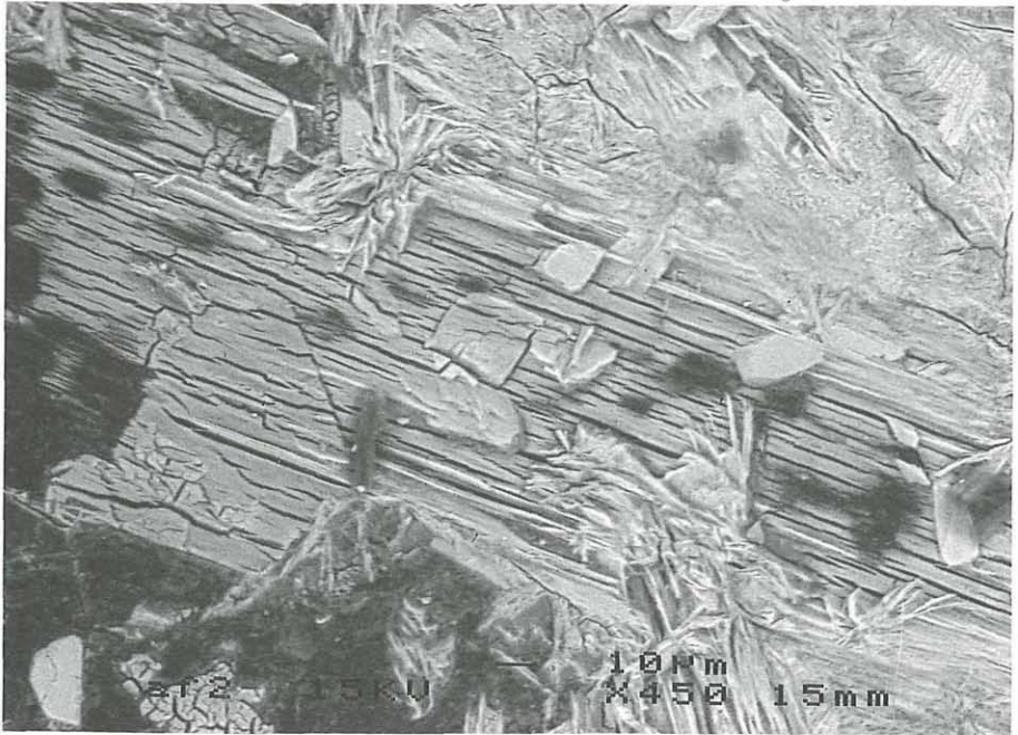
Abb. 3: Ettringit/Thaumasit mit deutlichen Rissen parallel z; Steinbruch Klöch, Nördlicher Bruch, Klöcher Klause, Steiermark, Österreich. REM: BSE-Bild. Bildbreite: 0,2 mm. Ettringite/thaumasite showing distinct fissures // z; basalt quarry Klöch, northern quarry, Klöcher Klause, Styria. BSE-image. Image width: 0,2 mm.
