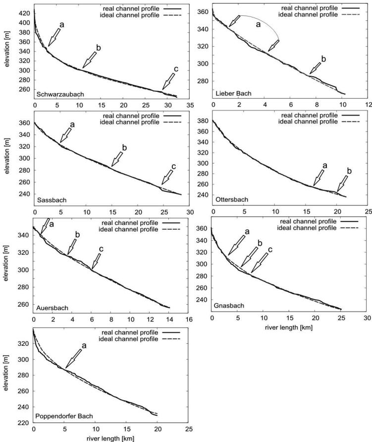
Abb. 5: Vergleich der Flussprofile (auf der Abbildung: durchgezogene Linie: „real channel profile“) mit den Reverenzkurven (auf der Abbildung: gestrichelte Linie: „ideal channel profile“) für jeden der sieben Flüsse. Die Anfangs- und Endpunkte des geplotteten Bereichs der einzelnen Flüsse sind auf Abb. 3a aufgetragen. Bereiche, wo die einzelnen Kurven voneinander abweichen sind mit Buchstaben markiert die mit jenen auf Abb. 3a übereinstimmen.
