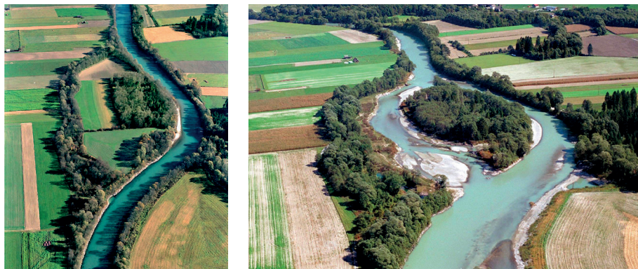
Abb. 7a (links): Drau bei Kleblach vor der Aufweitung 1999. 7b (rechts): nach der Aufweitung 2005. (Fotos: Amt der Kärntner Landesregierung, Abteilung 18 – Wasserwirtschaft Unterabteilung Spittal; aus EGGER et al. 2006).
