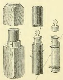
Boden und Deckel eingebrachtwerden, gegen Bruch gesichert. Das Glasgefäß ist mit einem gut eingeriebenen Glasstopfen versehen, der eventuell durch Pippenspeise vollkommen dicht eingedreht werden kann. Um Bewegungen der Blechkapsel innerhalb der Holzbüchse zu meiden, ist am Halse des unteren Theiles der Holzbüchse bei a ein Schlitz angebracht. In diesen Schlitz passen ausgebauchten stumpfen Bügel
