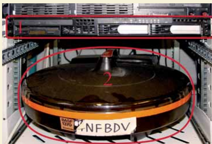
Abb. 3: Dual Opteron Server (1), 2005 und Festplatte des Großrechners IBM 370 (2). Derzeitiger ZOBODAT Zentralrechner (1). © M. Malicky
