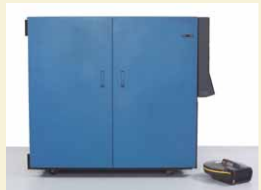
Abb. 2: Zentralprozessor der Type IBM 3145 und Festplatte des Großrechners IBM 370, ein Teil der Großrechneranlage, auf der die ZOODAT lief. © ÖÖ. Landesmuseen
