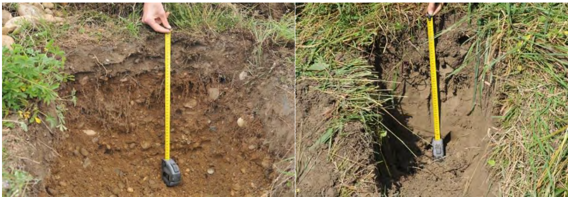
Abbildung 39. Bodenprofile nahe der Dammkrone (links) und am Dammfuß (rechts).
