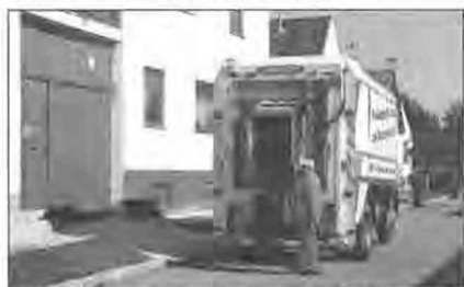
BMV-Müllwagen als Intelligenzbestie: Er schlägt Alarm, wenn er in der Biotonne Schad- und Störstoffe ortet.
