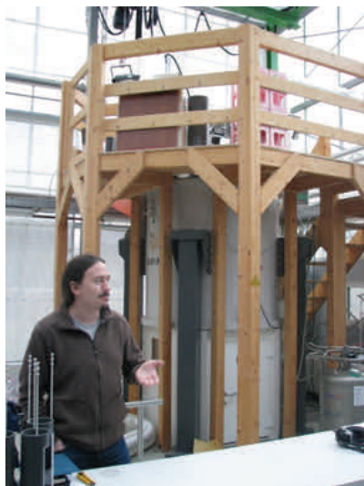
Abbildung 2: Besichtigung der Anlage mit angrenzendem RhizoScreen Anzuchtschalen (oben), und Besichtigung der Anlage mit dem EcoNMR 4,7 Tesla Magnet für 3-D Magnetresonanztomographie an Wurzeln in situ, die in der Lage sind, automatisch bis zu 20 pflanzengefüllte Röhrrchen (9 cm Durchmesser, 40 cm tief) pro Tag (unten) zu messen
