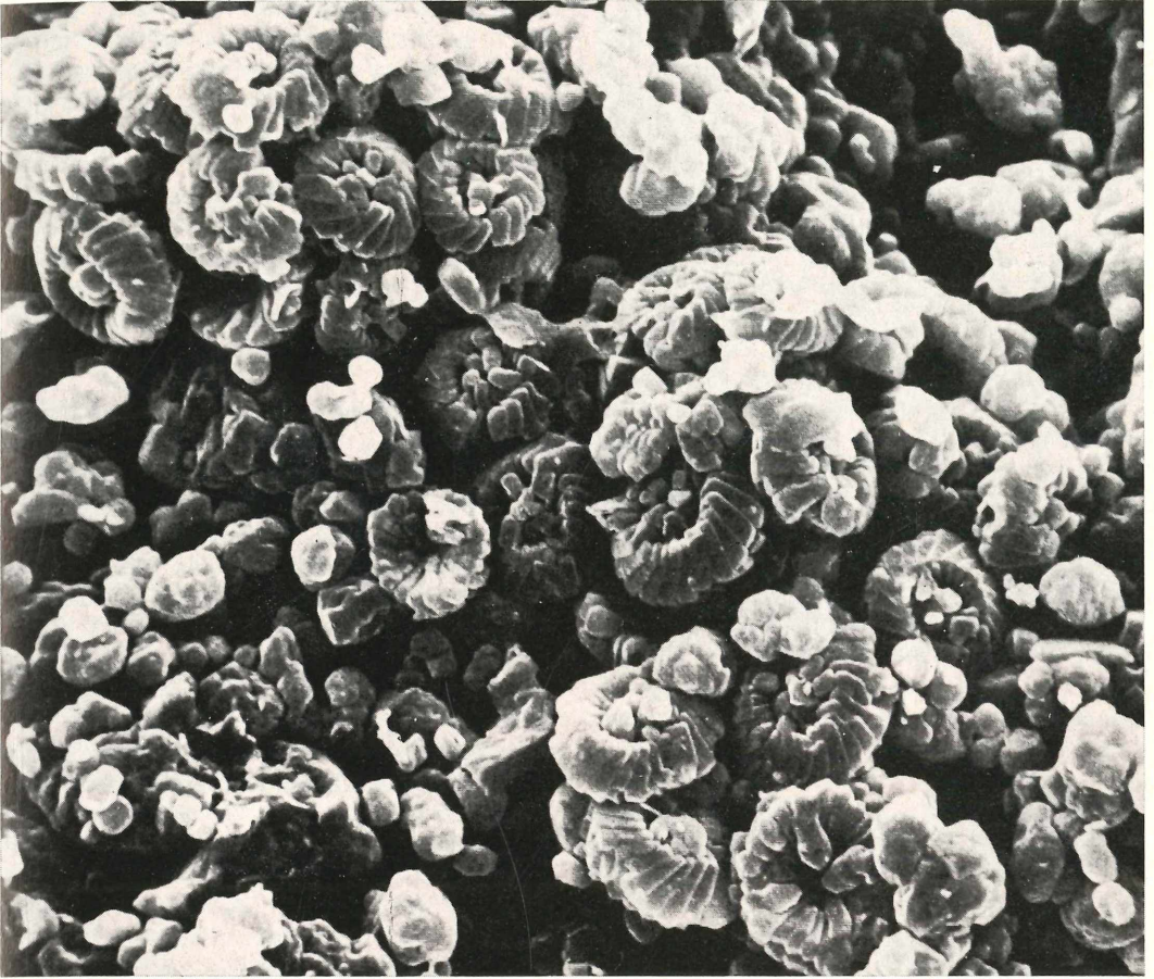
Abb. 10: Massenvorkommen von Cyclagelosphaera neben weitgehend angelösten Sedimentkörnern auf der Flinz-Oberfläche (Foto-Nr. 2171, REM-Probe S 70u-8, vergr. 4000 x).
