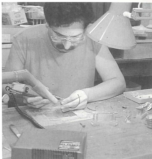
Entfernen von Oxyd von einer Bronze mit dem Ultraschallmeißel
