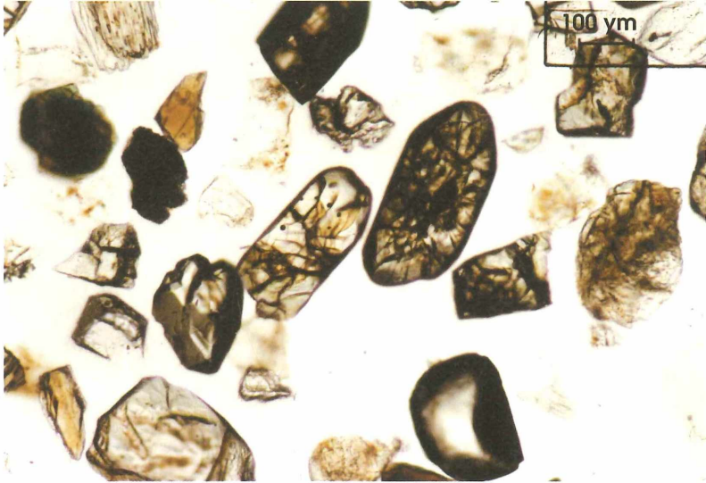
Abb.1: Gerundete, dunkel gefärbte Zirkonkristalle und eckige Quarze bilden die Hauptmasse der Schwermineralkonzentrate aus dem Gebiet im Passauer Wald.
