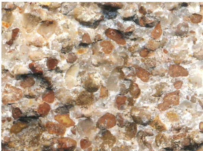
Abb. 15: In unserer Region findet man im Feuerletten Konglomerat-Lagen. Die Vorkommen scheinen allerdings seitlich nicht durchgehend gebildet bzw. erhalten worden zu sein. Die Komponenten der wiedergegebenen Probe bestehen aus gut gerundeten Karbonat- und Tonstein-Geröllen, die durch grobspätigen Calcit zementiert wurden. Die Karbonat-Komponenten könnten aus aufgearbeiteten Karbonatkrusten (siehe Abb. 16) stammen. Wegen der mitunter darin gefunden Knochenreste werden diese Konglomerate auch als Plateosaurus -Konglomerat bezeichnet. Probe aus Lesesteinfunden nördlich der Straße zwischen Stiebarlimbach und Greuth; Breite der abgebildeten Probe 3 cm. Foto: Autor.
