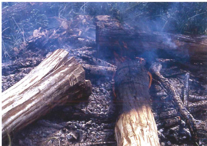
Abb. 4: Ankohlen der unteren Pfostenenden in einem Schwelbrand.
