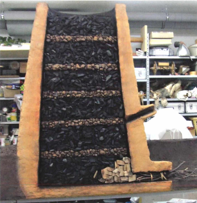
Abb. 3: Modell eines Rennofens, Originalgröße
