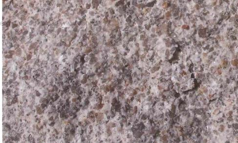
**Abb. 6:** Dolomitische Arkose des Mittleren Burgsandsteins: überwiegend grobe Quarz- und Feldspatkörner sind durch weißen, feinkörnigen Dolomit verbunden. Die Quarze sind durch den Transport zu ihrem Ablagerungsort mehr oder weniger stark kantengerundet. Zahlreiche glitzernde kleine Flächen zeugen allerdings von nach der Ablagerung ankristallisiertem Quarz. Probe: Lesestein vom *kbm*-Rücken oberhalb Thüngbach nördl. Schlüsselfeld. Bildbreite ca. 8 cm
