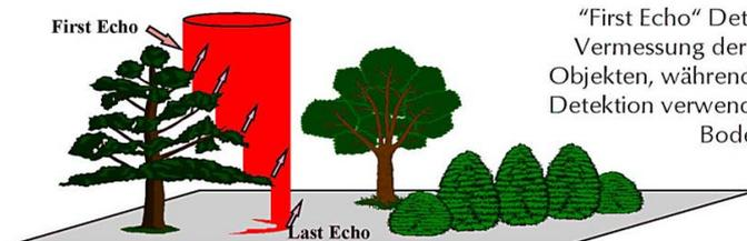
„First Echo“ Detektion ergibt die Vermessung der Oberkante von Objekten, während die „Last Echo“ Detektion verwendet wird, um den Boden zu vermessen
