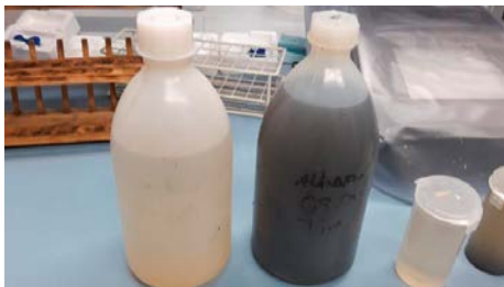
Abb. 13 Wasserprobe der Leine (links) und des Altwassers. Die deutliche Trübung resultiert aus dem Sapropel, das bis wenige Zentimeter unter die Wasseroberfläche reicht.
