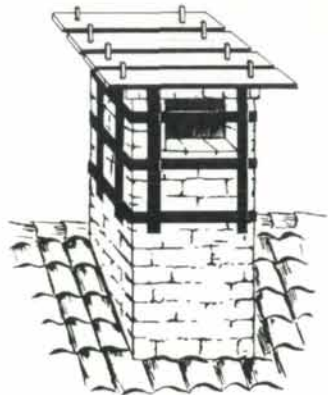
Abb. 3: Horstunterlage auf einem Kamin
