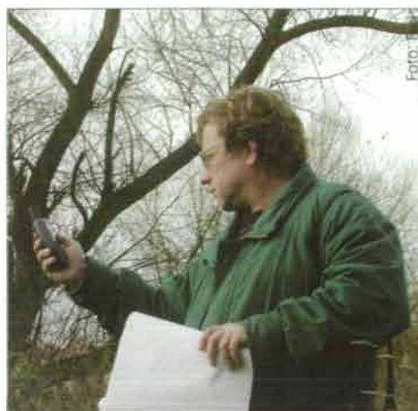
Herwig Talker hat alle Bodendaten mit dem GPS satellitengestützt verortet, um sie in ein digitales Geländemodell einarbeiten zu können. Für spätere Untersuchungen können die Einstichpunkte wieder genau aufgefunden werden.
