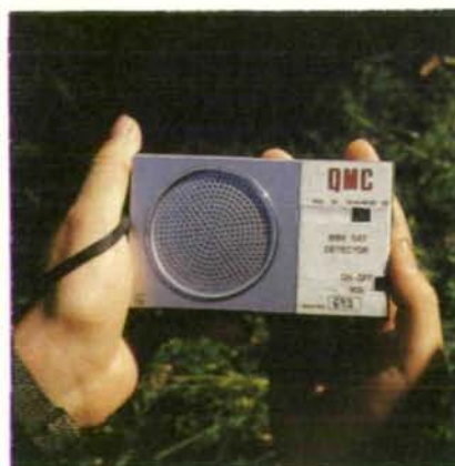
Abb. 5: Der Fledermausdetektor ist ein Gerät, mit dem die von den Fledermäusen ausgestoßenen Ultraschallrufe für den Menschen hörbar gemacht werden. Eine genaue Differenzierung der 24 Fledermausarten anhand ihrer Rufe ist mit diesem Gerät allerdings nur begrenzt möglich. Foto: K. Engl
