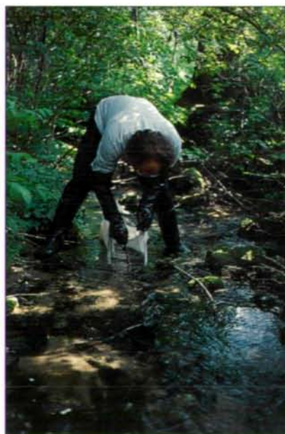
Abb.7: Im Rahmen des Grundlagenforschungsprogrammes wurden auch die Linzer Bäche und Flüsse eingehend untersucht. Hier wird gerade eine Probe aus einem Bachbett entnommen. Die Untersuchung der darin vorkommenden Organismen erlaubt Rückschlüsse auf die Wasserqualität des Gewässers.
