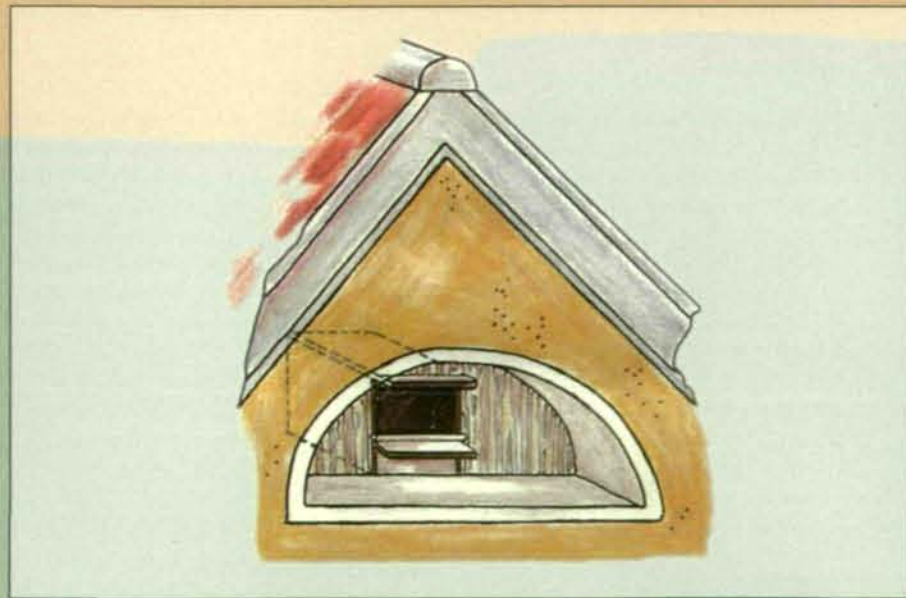
Abb. 5: Auch in eine Giebelluke, wie die hier skizzierte, kann ein derartiger Nistkasten montiert werden. Zu beachten ist wiederum, daß nach vorne-außen Platz für die Jungvögel zur Ertüchtigung der Flugmuskulatur gegeben ist. Im Bild wird dieser Platz durch die Mauerstärke im Lukenbereich zur Verfügung gestellt.
