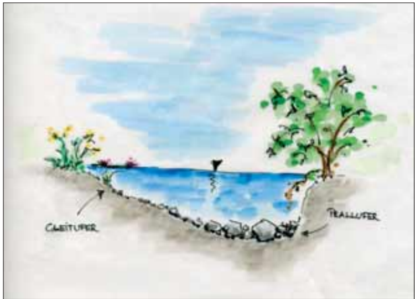
Abb. 10: Prall- und Gleitufer entstehen nur bei intaktem Geschiebetrieb und können, da dieser im Bindergraben fehlt, an Laufkrümmungen vorgegeben werden, indem man am Prallufer Material abgräbt und die Gleitufer abflacht.
