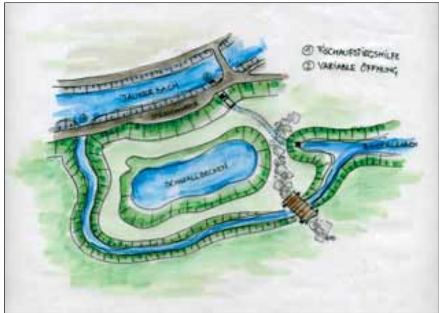
Abb. 8: Schematische Darstellung der Verbindung zwischen Jaukerbach und Feilbach: die Fischlaufstieghilfe mit immer gleicher Wasserführung wird, um die erforderliche Höhe zu erreichen, rund um das Schwallbecken angelegt, mit der variablen Öffnung wird die Wassermenge reguliert.
