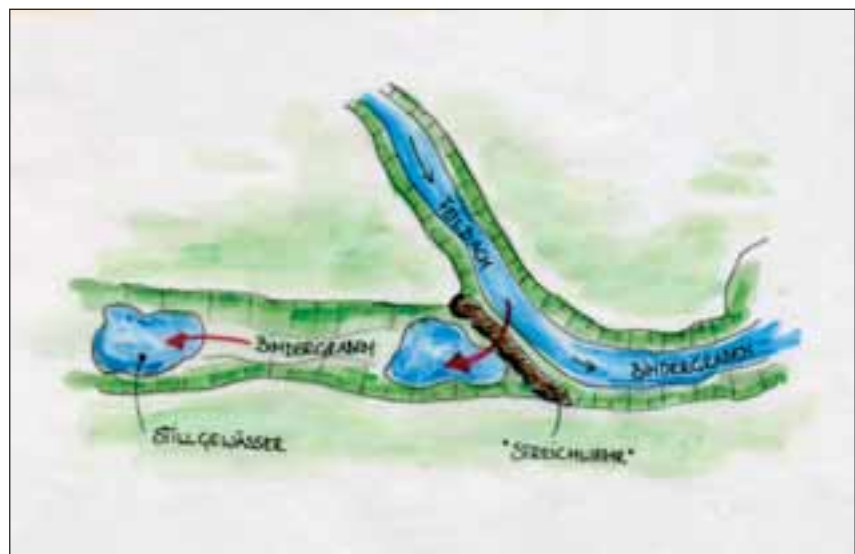
Abb. 9: Bei höherer Wasserführung wird der Bindergraben flussaufwärts gespeist; in den Senken bilden sich temporäre Stillgewässer. Ein Streichwehr verhindert, dass das Wasser zu schnell abfließt.
