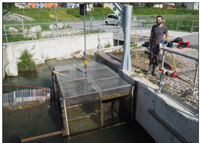
Abb. 13: Mai 2017: Bergung der Reusen, mit denen die Funktionsfähigkeit der Organismenwanderhilfe am Kraftwerk Enns überprüft wird. Rechts: Reusenteil für absteigende Fische, links für aufsteigende Fische. Der Gewässerökologe Christoph Graf MSc (Fa. blattfisch e.U., Wels) bestimmt und vermisst jeden Fisch, bevor er zurückgesetzt wird.
