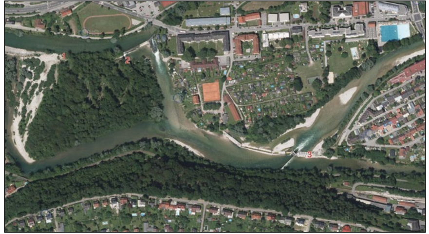
Abb. 16: Maßnahme 5, Organismenwanderhilfe am Annawehr: 1: Oberes Ende des neu angelegten Bachlaufs durch die Insel bei St. Anna. Sein gewundener Verlauf im Auwald ist erkennbar. 2: Unteres Ende beim Annawehr. 3: Maßnahme 6, mit Gittern abgedeckte, technische Fischaufstiegshilfe am Kugelfangwehr. Wertvollste Kiesstrukturen und Auwaldbiotopie liegen hier mitten in der Stadt!
