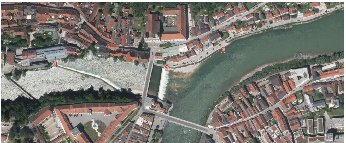
Abb. 19: Zwischenbrücken heißt dieser zentrale Ort in Steyr. 1: Organismenwanderhilfe am Haindmühlwehr. Oberhalb des Wehrs ein Steg, unterhalb die Steyrbrücke und dann das hohe Spitalmühlwehr, Einmündung in die Enns. Sein Fischaufstieg zwischen 2 und 3.
