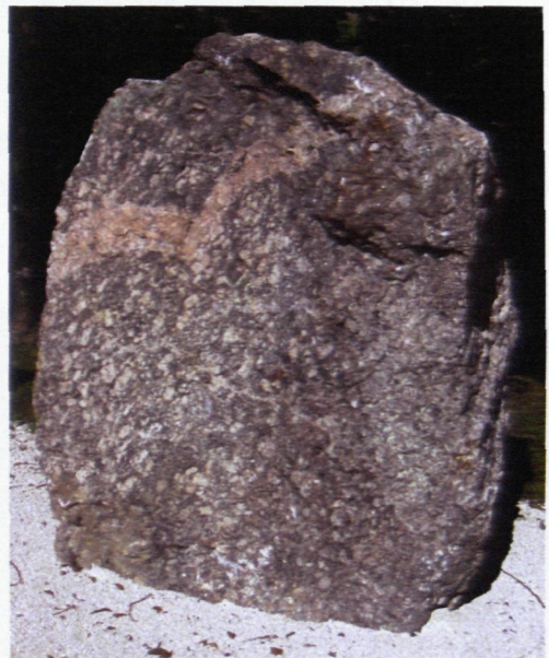
Abb. 2: Der Weinsberger Granit aus dem östlichen Mühlviertel. Dieser Typus ist durch Kalifeldspäte gekennzeichnet, im oberen Teil ein verfälteter Pegmatitgang.
