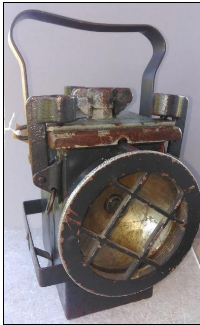
Abb. 10: Akkulampe von Frimann und Wolf, Baujahr 1942, verwendet im Ischler Erbstollen. Sammlung: P. Arthofer, Steyr
