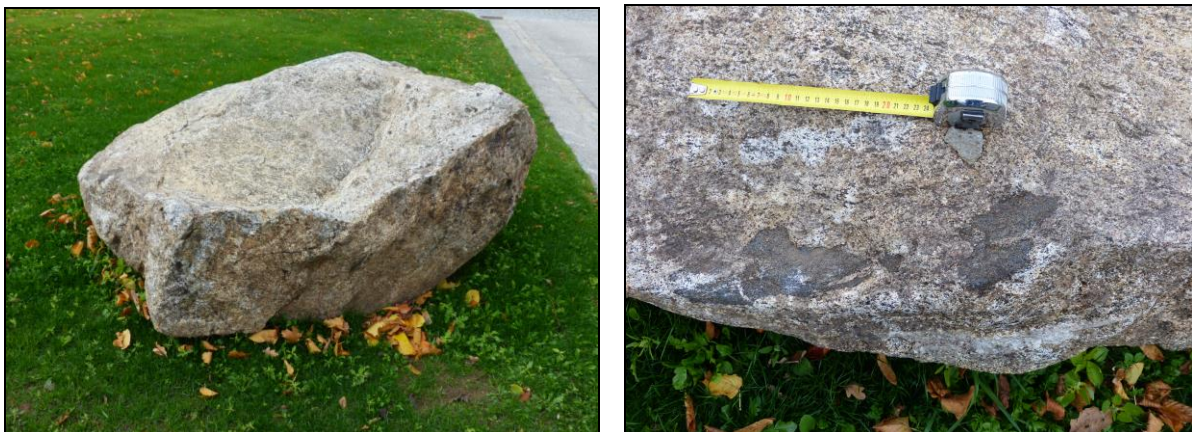
Abb.2 (links): Der größere Gesteinsblock mit den Maßen 190 x 130 x 80 cm zeigt massige und schlierige Anteile.
