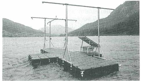
trolle und das Kabel. Die Gehege werden falltiefenfrei in ein starkes Niro- oder Aluminiumgestell gespannt. Ein effizienter Solar-Generator wird für autonome Funktion in abgelegenen Gebieten geliefert. Für den Anschluß an einen Stromkreis wird ein Transformator geliefert, um das Risiko elektrischer Unfälle bei hohen Voltzahlen zu verhindern.
