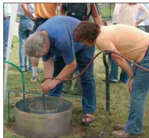
Messung der Versickerungsintensität
