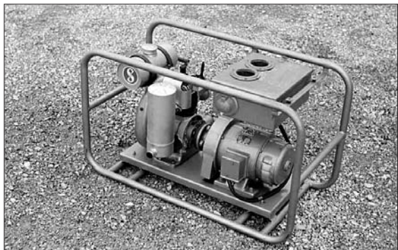
Abb. 1: 1-kW-Elektrofischerei-Aggregat, Typ Elin, aus dem Jahr 1960
