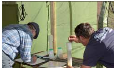
An drei Kontrollstellen wurden alle 15 Minuten Wasserproben zur Ermittlung des Feststoffgehaltes des Wassers entnommen.
