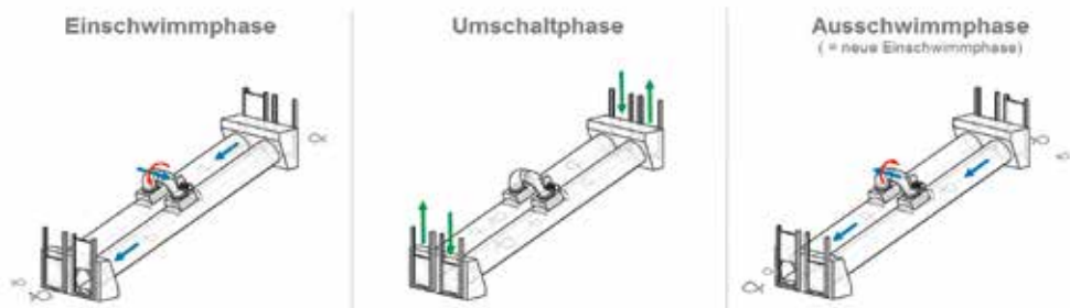
Abb. 3: Funktion der 2-Kammern-Organismenwanderhilfe
