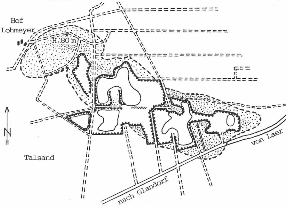
Abb. 1a Aufschlußverhältnisse 1951 (Geolog. Karte aus KELLER 1951: 354; Erläuterungen: ds = saale-eiszeitlicher Sand, dg = saale-eiszeitlicher Kies. Die Zahlen 1–15 bezeichnen die einzelnen kleineren Aufschlüsse.)
